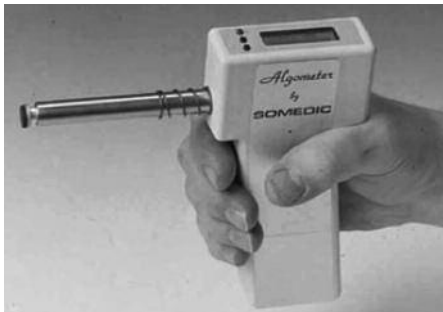
Ryc. 2. Algometr elektroniczny Somedic® typ 2 Fig. 2. Electronic algometr Somedic® type 2
