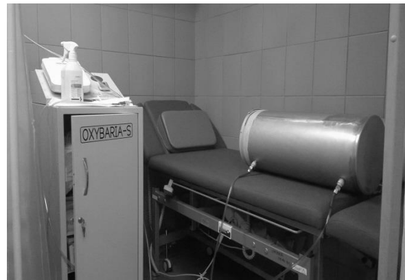
Fig. 2. OXYBARIA-S device for localised hyperbaric oxygen therapy. Ryc. 2. Aparat OXYBARIA-S do prowadzenia zabiegów miejscowej hiperbarycznej terapii tlenowej.
