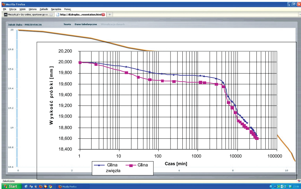
Rys. 7. Wyniki otrzymane przy badaniu konsolidacji utworów czwartorzędowych z terasy Wisłoka
