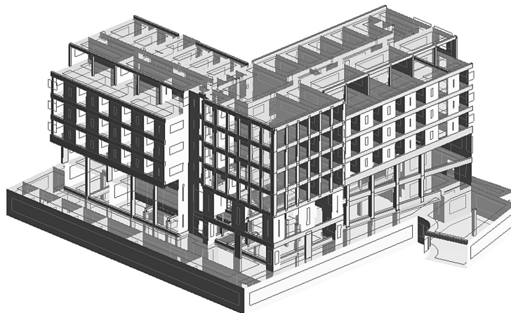
Rys. 4. Model obliczeniowy konstrukcji budynku w systemie MES
