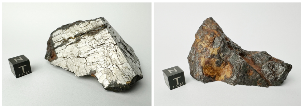
Rys. 8. Meteoryt Canyon Diablo, oktaedryt gruboziarnisty IAB, pięćka o wadze 204,3 g. Po lewej stronie przekrój z figurami Widmanstättena, po prawej stronie powierzchnia zewnętrzna.
