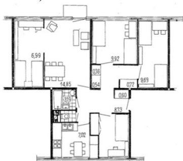
Ryc. 1. Mieszkanie o powierzchni użytkowej 72, 45 m 2 realizowane w systemie OWT - 67
